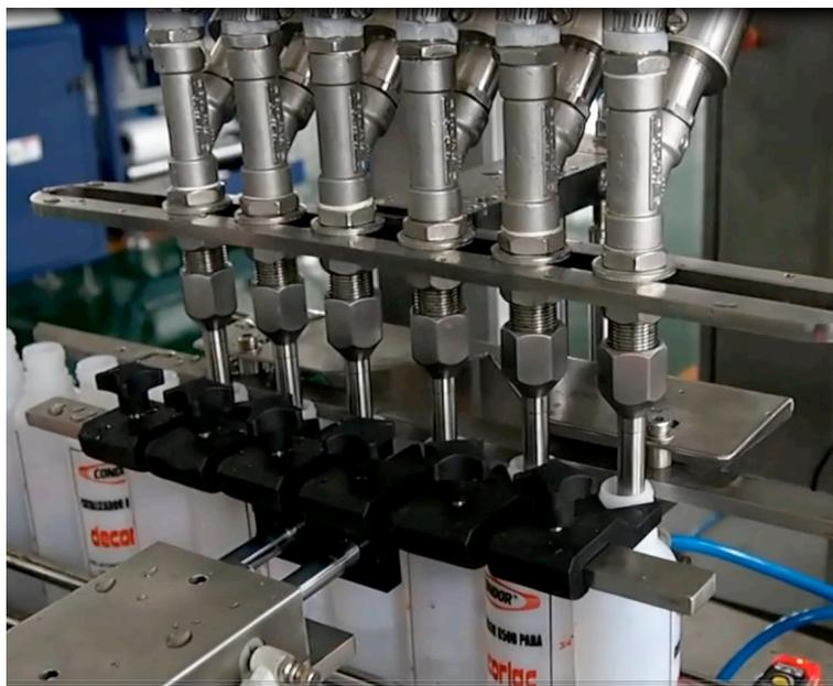
Posteriormente se bombea con una bomba Atex a la llenadora, que estará clasificada Clase II y que procederá al llenado de envases desde 50ml y hasta 1 litro con un sistema volumétrico de alta precisión de llenado. Tras el llenado debemos tapar los envases, contando con una taponadora versátil capaz de alimentar y roscar los tapones fliptop y roscar las bombas previamente alimentadas de forma manual.
